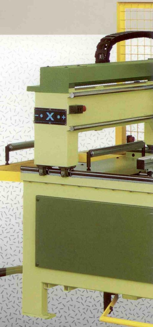
**1** Testa di foratura con cinque mandrini verticali indipendenti ed un mandrino doppio orizzontale, aggregato sega (opzionale) per incisioni longitudinali. Corsa verticale su guida lineare, azionamento pneumatico con frenatura idraulica. 5 battute di profondità gestite dal controllo in automatica.
