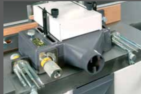
Zware, stabiele freesaanslag (max. dia. werktuig 250 mm) met fijninstelling en voorprogrammeerbare aanslag 8 posities.
