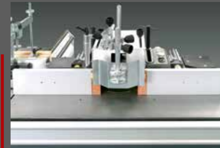
OPTIE Beschikbaar als optie: geanodiseerde aluminium freesaanslag-platten.
