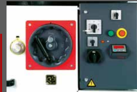
Hoogte-instelling door middel van een handwiel, als optie verkrijgbaar: digitale uitlezing en motorisch aangedreven hoogteverplaatsing van de freesdoorn.
